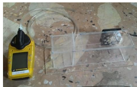
รูปที่ 2 อุปกรณ์และเครื่องวัดแก๊สสำหรับทดสอบคุณสมบัติการดูดซับกลิ่นของผนัง
