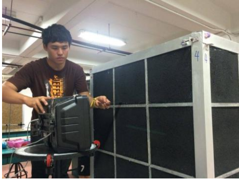
รูปที่ 3 เครื่องกำเนิดเสียงและห้องตัวอย่าง
