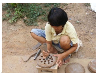
ภาพที่ 3. การเจาะรูแผ่นรังผึ้งเตาอั้งโล่
