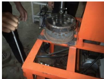
ภาพที่ 8 การยกหัวปั๊ม(Punch)ขึ้นหลังจากเจาะ
