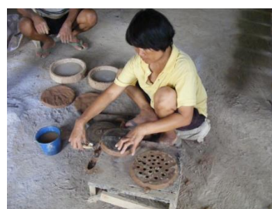
ภาพที่ 4. การกรัดขอบด้านข้างแผ่นรังผึ้งเตาอั้งโล่
