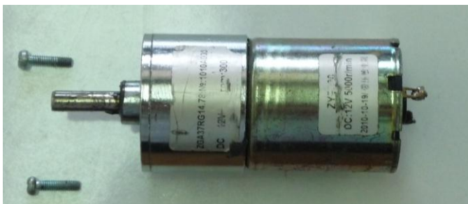
รูปที่ 11: แสดงมอเตอร์ที่ใช้ DC 12 โวลต์เพื่อใช้เป็นกำลังเขย่าถาดยัดขวดยาฉีด
