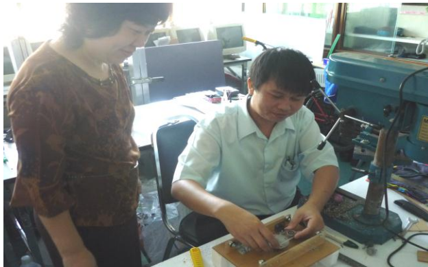
รูปที่ 7: แสดงการประกอบติดมอเตอร์กับลูกเบี้ยวกับส่วนฐานเคลื่อนที่ของเครื่องเขย่าขวดยาฉีด
