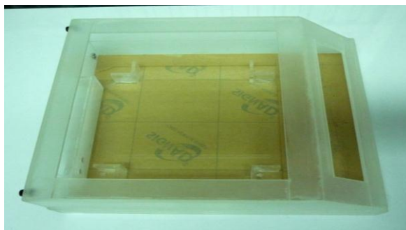
รูปที่ 14 : แสดงโครงสร้างรองรับฐานเคลื่อนที่ของเครื่องเขย่าขวดยาชนิดที่ประกอบแล้ว พร้อมติดที่ยึดหนีตกับส่วนที่เป็นฐานของโครงสร้างดังกล่าว
