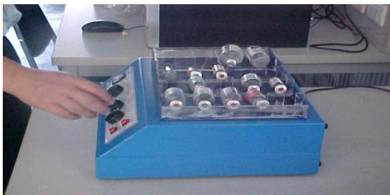
รูปที่ 26: แสดงถาดยัดขวดฉีดยาขณะเขย่าที่ประกอบเข้ากับแผ่นรับถาดยัดขวดฉีดยาขณะเขย่า
