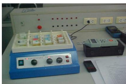
รูปที่ 27: แสดงการหุ้มถาดยัดขวดฉีดยาขณะเขย่าด้วยฟองน้ำแข็งแบบบางด้านที่ยัดขวดฉีดยาเพื่อป้องกันแรงกระแทกและลดความดังของเสียงดัง
