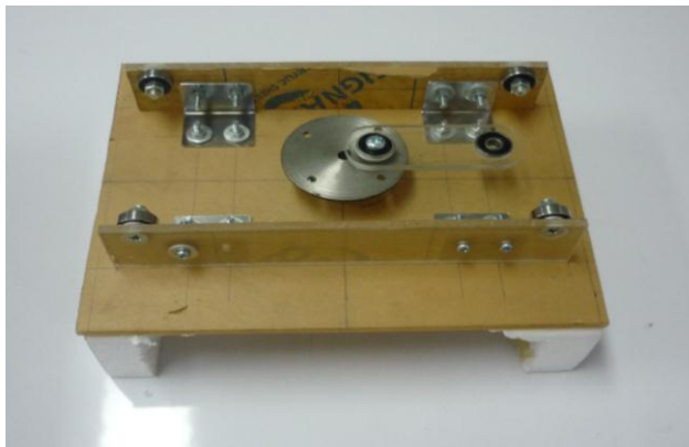
รูปที่ 8: แสดงส่วนฐานเคลื่อนที่ของเครื่องเขย่าขวดยาฉีดที่ประกอบเสร็จแล้ว
